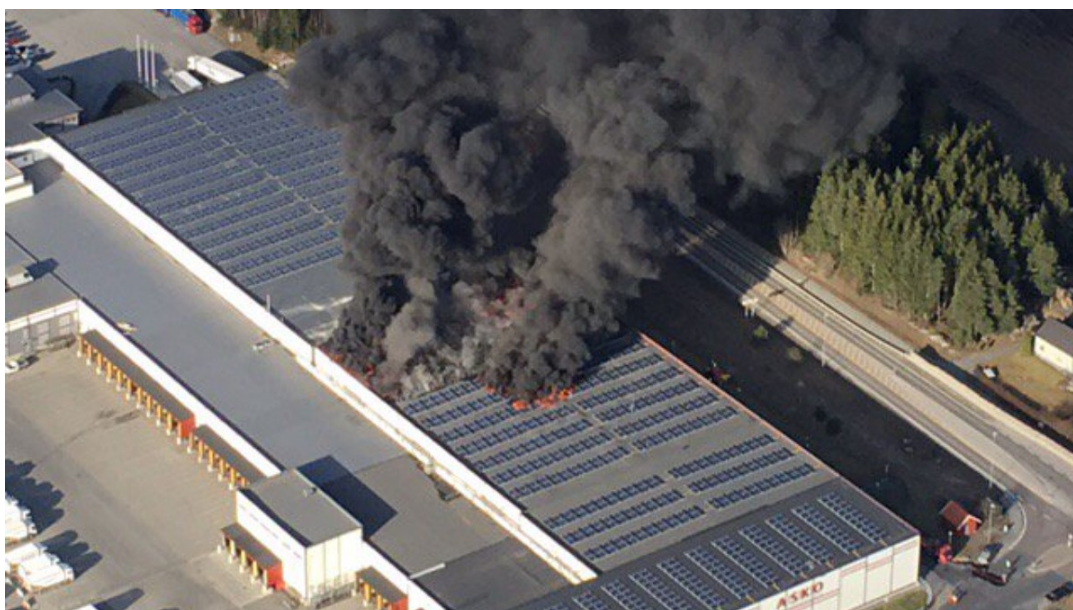
Figur 4-2: Oversiktsbilde over ASKO-bygget under brannen, bildet er tatt en gang mellom kl. 17-21, fredag 7.april (fase 1 av brannen). Bildet viser hvor det var montert solcellemoduler på tak, på den delen av bygget som tilsvarer høyre del av kartutsnitt fra Figur 4-1. Foto av Øst politidistrikt, gjengitt med tillatelse.
