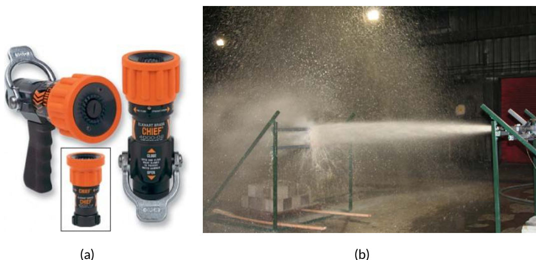
Figur 3-2: (a) Det justerbare strålerøret som ble brukt i forsøkene fra UL LLC, av typen pistolgrep med kobling til 1-1/2" slange. Strålen kunne varieres fra samlet stråle til bred spredning. (b) Vannstråle rettet mot spenningssatt kobberplate. Figuren er hentet fra rapport av Backstrom og Dini, gjengitt med tillatelse fra UL LLC [47].
