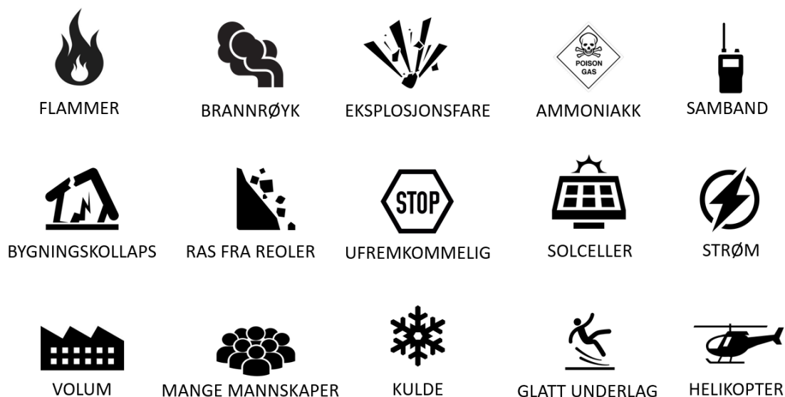
Figur 4-5: Risikofaktorer i forbindelse med ASKO-brannen. Solceller var én av mange risikofaktorer i denne brannen. Figuren er fra [63], gjengitt med tillatelse.
