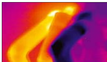
Figur 8.1 Termofotograferte rør. Kilde: Glava
