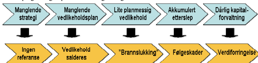
Figur 8.1.1 Veien til verdiforringelse
