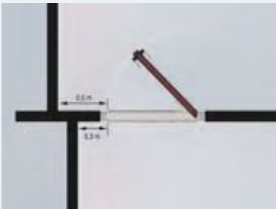
§12-15 Figur 5: Nødvendig sideplass ved dør med belastning.
