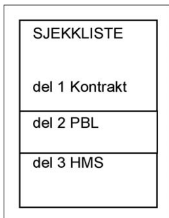
Fig. 63 Figuren viser prinsippet om en tredelt sjekklister, som omfatter kontrollpunkter for alle de tre kravområdene (HMS, kontrakt, PBL) for den aktuelle fasen i byggearbeidet.
