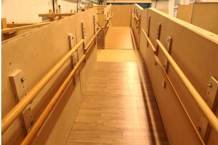
Figur 2-2: Deler av testoppsettet for de to korteste strekkene i rampen
