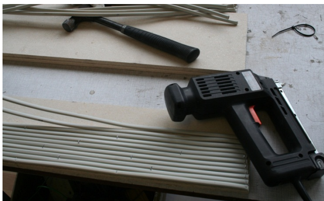
Figur C- 7 Klargjøring av prøvestykker for flammespredning. Kablene ble stiftet på en kalsiumsilikatplate av passende størrelse.
