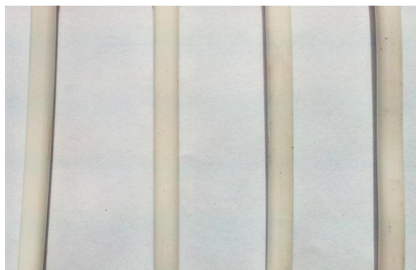
Figur 3-2 Visuelle endringer av den PVC-baserte kabelisolasjonen etter aldring. Aldring i uker fra venstre: 0, 4, 8 og 16.
