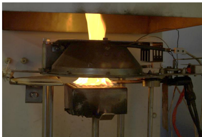
Figur 3-4 Prøving av kabler i konkalorimeteret (ISO 5660).
