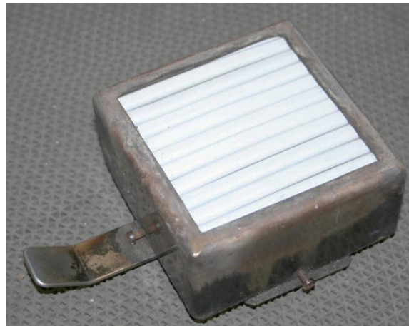
Figur 3-3 Kabler i prøveholder for test i konkalorimeter (ISO 5660).
