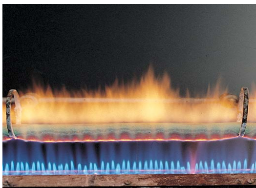
Test i henhold til NEK IEC 60331-21. Foto: Cavicel, Italia ( www.cavicel.com )
