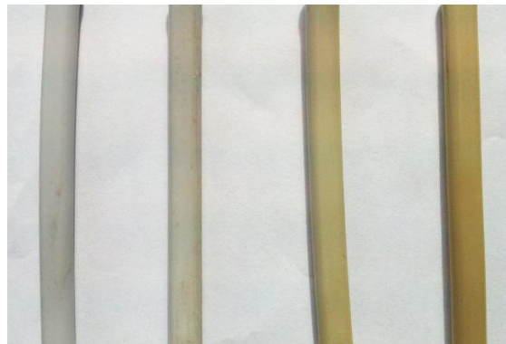
Figur 3-1 Visuelle endringer av den halogenfrie kabelisolasjonen etter aldring. Aldring i uker fra venstre: 0, 4, 8 og 16.
