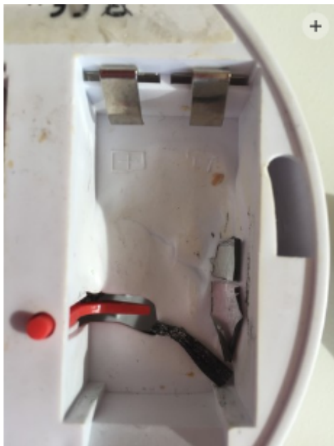
Bilde 5 viser en smeltet batterilomme til en røykvarsler, ukjent merke, arkiv nr. 17/5845
