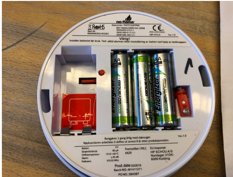
Bilde 2 Bildet viser røykvarsler modell LM-101LG med rød merking der batteriet skal settes inn. Bildet er mottatt fra tipser.
