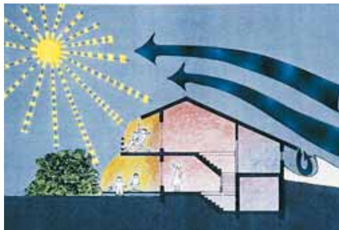
Når det blåser som verst, snur vi ryggen mot vinden. Dette huset har også snudd ryggen mot vinden, slik at vinden løftes opp over taket. Tegning: sivilarkitekt Are Rødsjø
