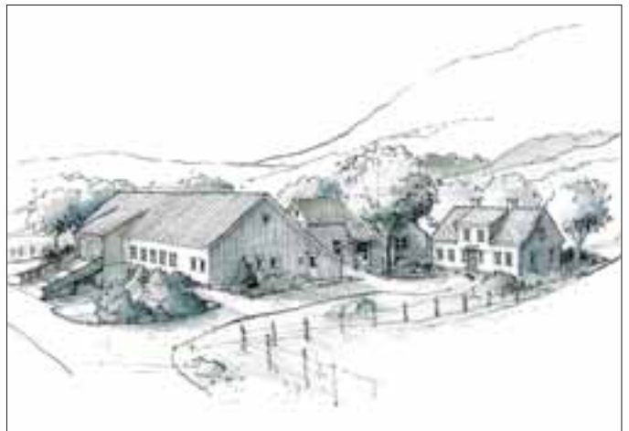
Nybygg på gårdstun bør legges i tilknytning til eksisterende bebyggelse. Det nye kårhuset er tilpasset tunet, og siloen er gravd ned. Tegning: Edna Tonning, i veilederen Lokal byggeskikk i Hjelmeland 1993
