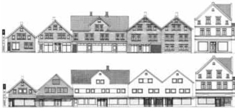
Tegningen viser husfasader i Storgata i Sandnes i 1920 og i 1992. Alle hus har fått kappet av førsteetasjen ved hjelp av et «magebelte» av reklamer og markiser. Tegning fra Byggeskikk i Sandnes
