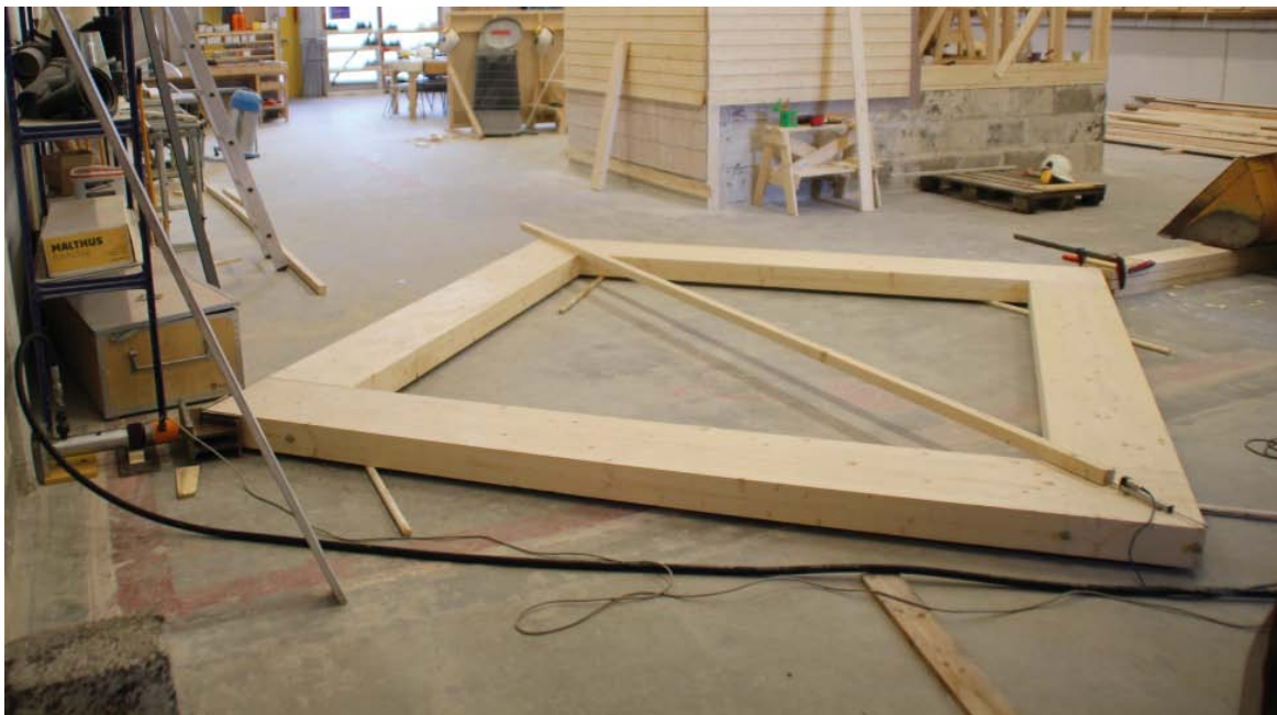
Limtreramme plassert i rigg for påføring av last. Hydraulisk lastcelle til venstre. Til høyre måleinstrument for avlesing av deformasjon.
