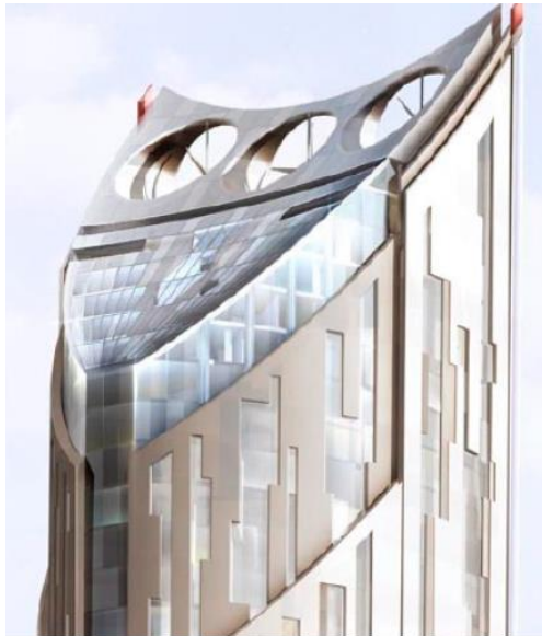
Figur 7-3: Eksempel på bygningsintegrert horisontalakse vindturbin (Strata SE 1, London). Bilde fra SINTEF-rapport 17
