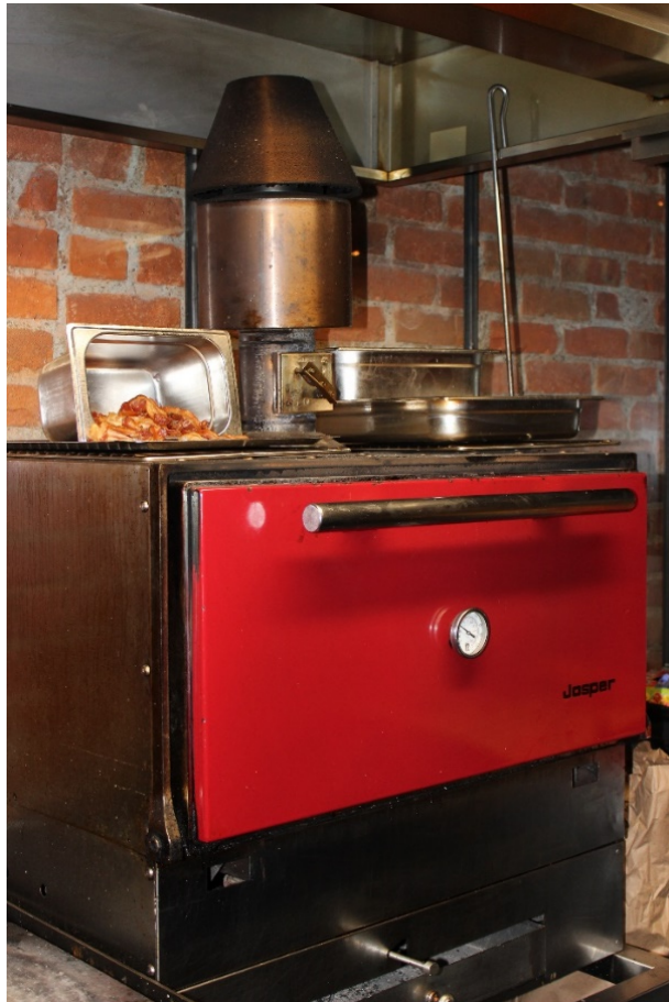
Figur 3-6 Lukket kullgrill med spjeld over og under, samt gnistfanger og kjølehette på toppen av ovnen.
