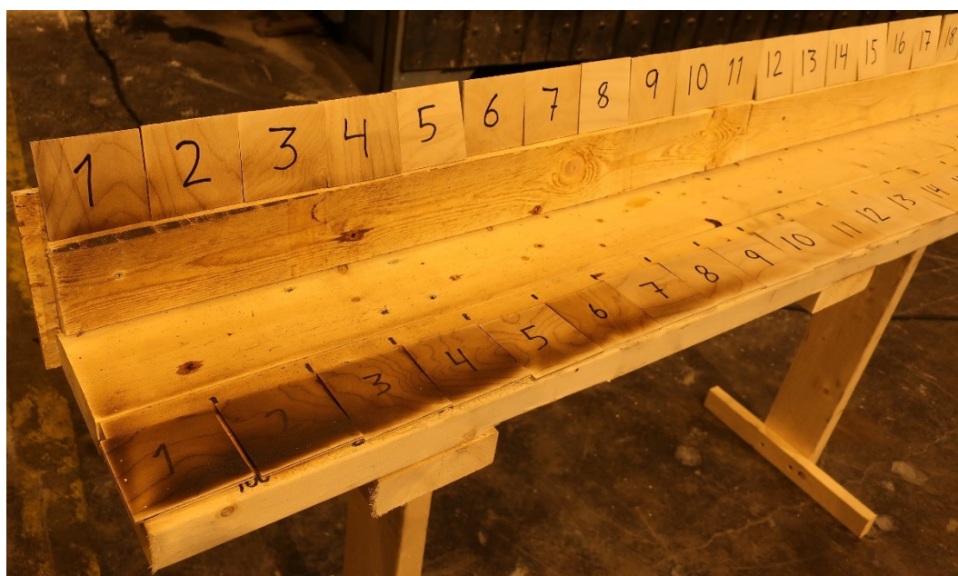
Figur 4-21 Kryssfinerplater og nettverkskabel utsatt for stråling fra kanal oppvarmet etter isokurven i 60 minutter (test R1). Kryssfinerplatene på raden nederst var posisjonert horisontalt 100 mm fra kanalens underside, mens kryssfiner-platene på raden over var posisjonert vertikalt 150 mm fra kanalens side. Plate nr. 1 var plassert 25 cm fra ovnen.
