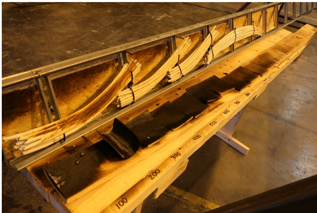
Figur 4-20 Kryssfinerplater og nettverkskabel utsatt for stråling fra kanal oppvarmet etter isokurven i 60 minutter (test R2). Kryssfinerplatene var posisjonert i 50 mm avstand fra underside av kanal, og bunter av nettverkskabel i 100 mm avstand fra siden av kanalen. Nærmeste kryssfinerplate og kabelbunt befant seg 25 cm fra ovnen.
