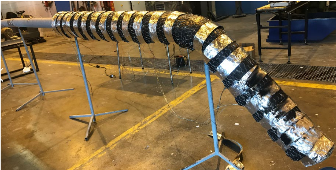
Figur 4-14 Etter at kanalen ble koblet fra ovnen, klarte ikke røret å holde sin egen vekt oppe, og sank sammen. Bildet er fra test 23.
