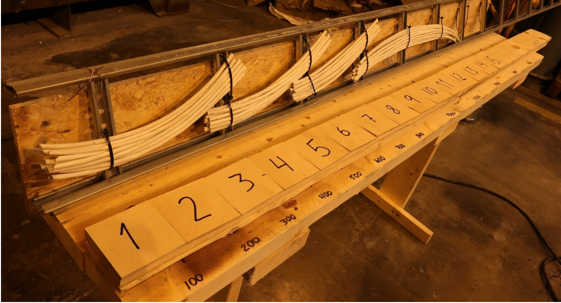
Figur 3-7 Kryssfinerplater posisjonert 50 mm fra undersiden av kanalen, og ti lengder med nettverkskabler i bunter posisjonert vertikalt 100 mm fra siden av kanalen før test.
