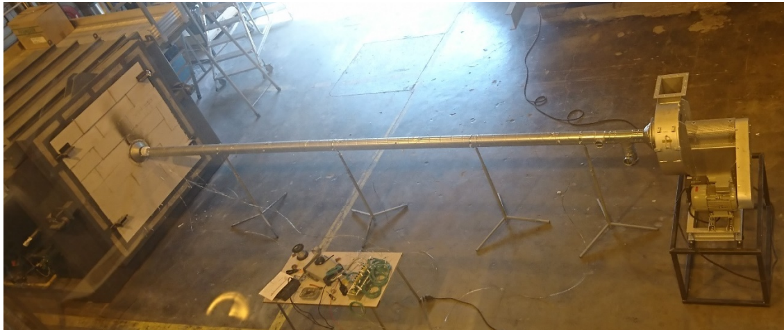
Figur 3-11 Et oversiktsbilde av forsøksoppsettet. Bildet viser en uisolert ventilasjonskanal med 125 mm diameter, uten innblanding av romtemperert luft, som er koblet til ovnen i venstre ende, og vifta i høyre ende. Kanalen er støttet opp med støttebein fra undersiden.
