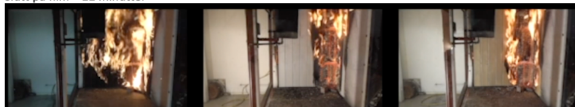
Figur 5.6 Bilder tatt fra filmen av branntester av royalbehandlet trekledning, malt trekledning beiset trekledning
